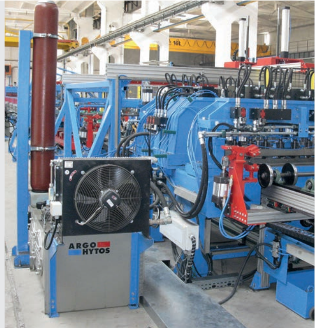
Linie für Blechlochung, angetrieben von Hydrauliksystemen, die vom ARGO-HYTOS Polen Team entwickelt, gebaut und in Betrieb genommen wurden.
