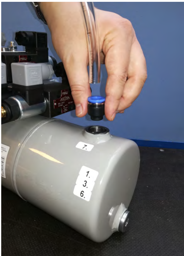
Abbildung 7: Verschließen des Hydraulikschlauchendes mit einem Stopfen
