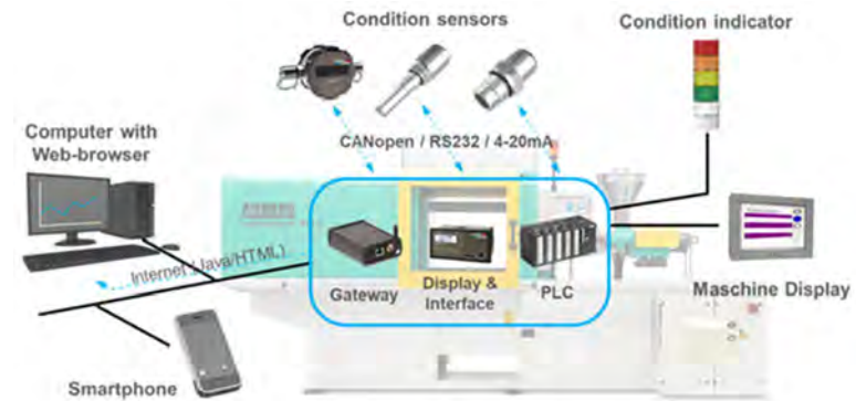
Abbildung 2: Aufbau einer Fernüberwachung des Ölzustands
