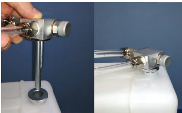
Abbildung 6: Installation des Saug-Rücklauf-Sets in einen Kunststofftank
