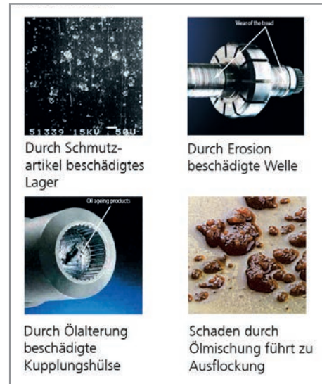
Durch Zustandsüberwachung erkennbare Schäden
