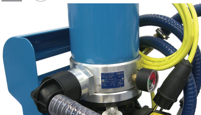
FA 016 mit eingeschraubtem Saugsieb-Set FA 016.1775
