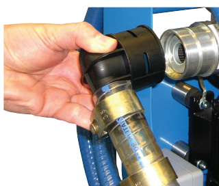
FA 016 mit eingeschraubtem Saugsieb-Set FA 016.1775
