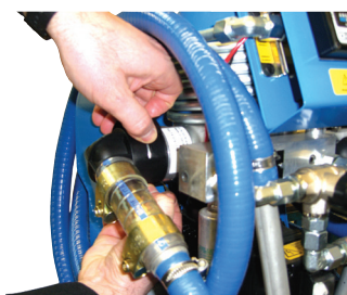
FA 016 mit eingeschraubtem Saugsieb-Set FA 016.1775
