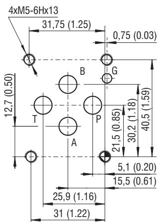
Kanäle P, A, B, T - max.  $\varnothing 7,5 \text{ mm}$  (0.29 in)
