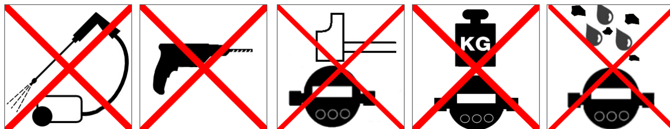
Obr. 9: Nepřípustné mechanické namáhání
