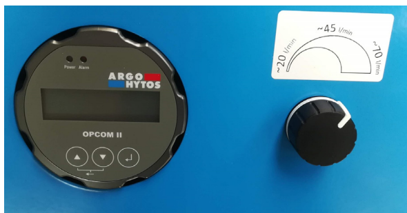
Obr. 12: Čelní panel s potenciometrem pro nastavení průtoku
