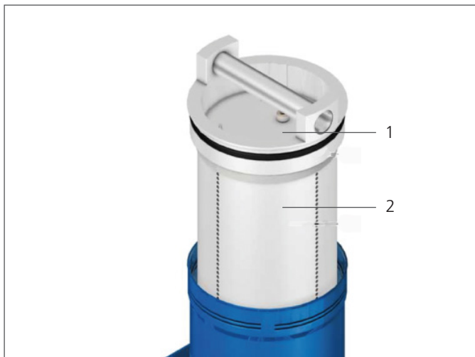
Obr. 17: Vyjmutí filtrační vložky
