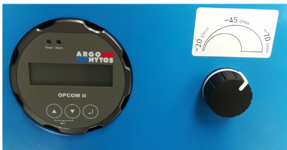
Fig. 12: Frontpanel mit Potentiometer zur Durchflusseinstellung
