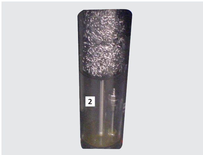
Abb.16: Sichtfenster Auffangbehälter Kondenswasser
