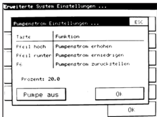
Obr. 16: Nastavení proudu čerpadla
