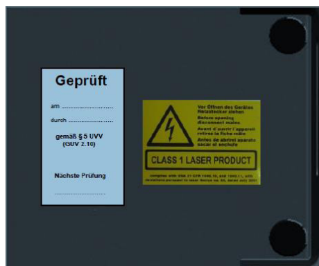
Obr. 1 Spodní strana přístroje se záznamem zkoušky el. proudu a upozornění na laserovou ochranu
