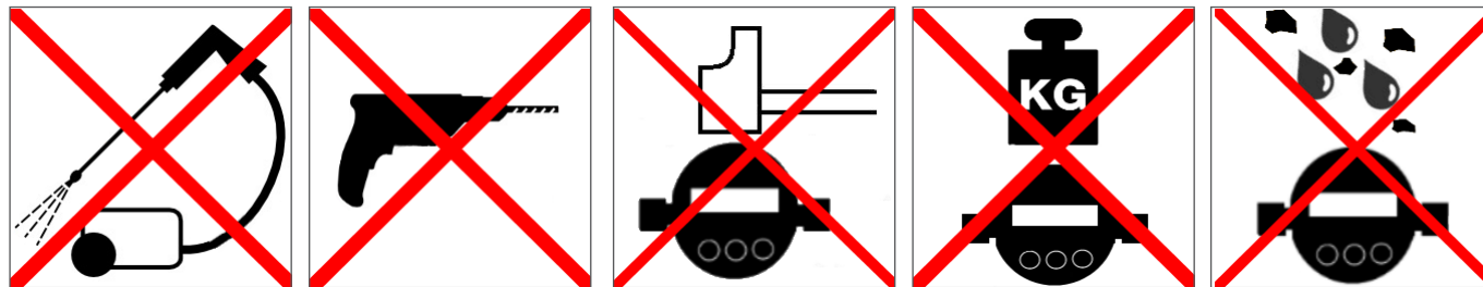
Abb. 9: Unzulässige mechanische Belastungen
