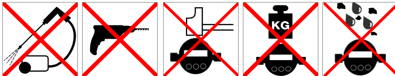
Obr. 9: Nepřípustné mechanické namáhání
