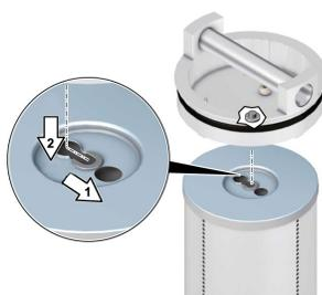
Abbildung 6: Filterelement abnehmen
