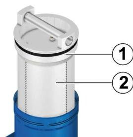
Abbildung 5: Filterelement ausbauen
