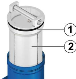
Abbildung 8: Filterelement einbauen
