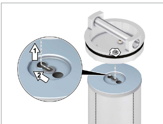
Obr. 8: Připojení filtrační vložky k víku
