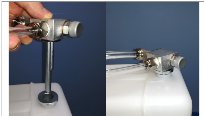
Obr. 17: Instalace sady sání - výtlak do plastové nádrže
