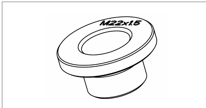
Obr. 3: Doplnkové komponenty: Ocelový adaptér pro instalaci do plastových nádrží
