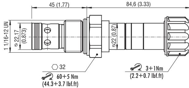
**Manuelle Notbetätigung** in Millimeter (Inch)
