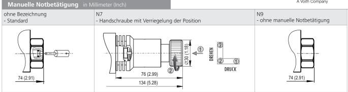
Bei einer Fehlfunktion des Elektromagneten oder bei einem Stromausfall kann der Ventilkolben manuell betätigt werden, sofern der Druck in der Rückleitung 25 bar nicht übersteigt.
