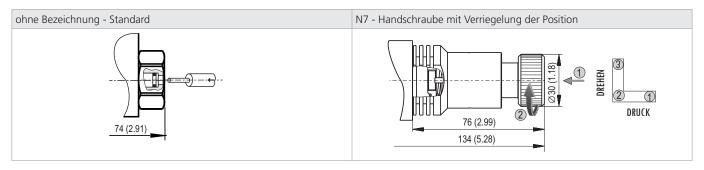
Bei einer Fehlfunktion des Elektromagneten oder bei einem Stromausfall kann der Ventilkegel manuell betätigt werden, sofern der Druck in der Rückleitung 25 bar nicht übersteigt.
