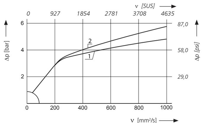
**Kennlinien für die Filtereinheiten in der Auswahltabelle, Spalte 4**
